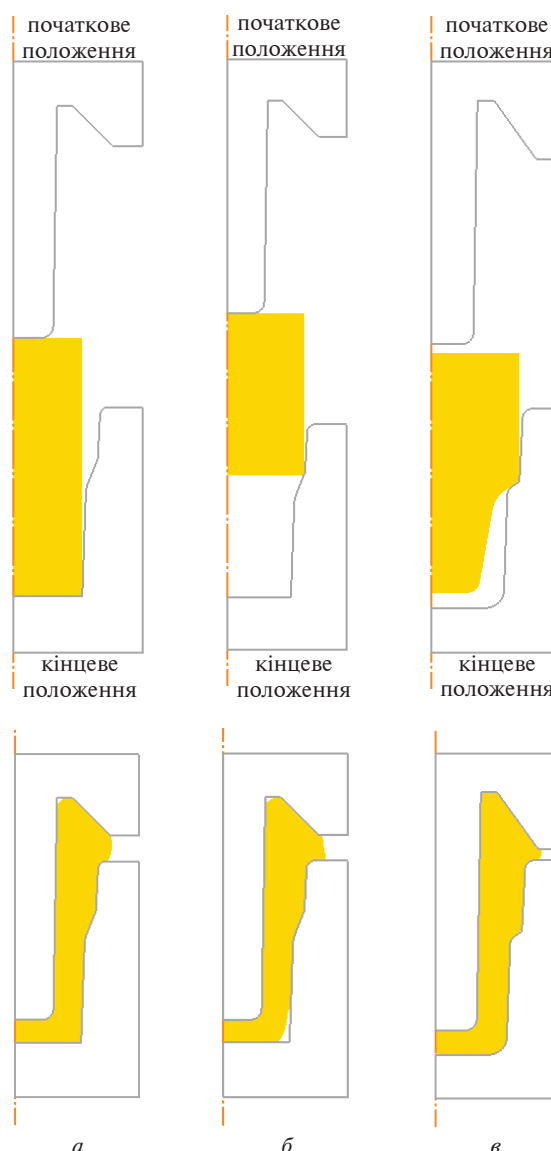
Рис. 4. Варіанти штампування напівфабрикату виробу із заготовок різного діаметра: а – одноопераційне штампування із заготовки діаметром 48r90,4; б – одноопераційне штампування із заготовки діаметром 58r61,9; в – штампування після попереднього формування заготовки діаметром 58r61,9
